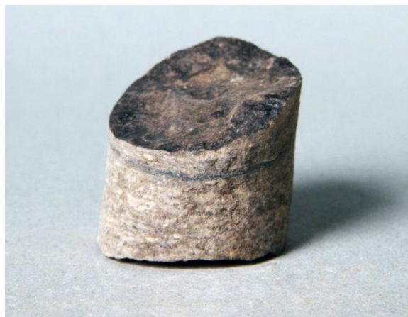
Рис. 4.19. Алэксинский горизонт. Известняк (кern с глуб. 2510 м). Ореховская опорная скважина. СОИКМ.
