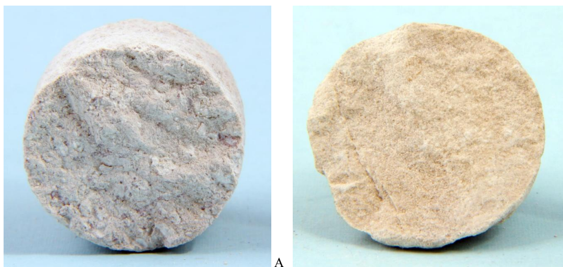
Рис. 4.35. Краснополянский горизонт. А – известняк (кern с глуб. 2116 м); Б – доломит (кern с глуб. 2102 м). Ореховская опорная скважина. СОИКМ.
