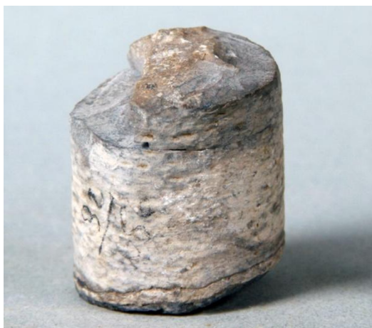
Рис. 4.46. Каширский горизонт. А – известняк (кern с глуб. 1850 м); Б – ангидрит (кern с глуб. 1872 м). Ореховская опорная скважина. СОИКМ.
