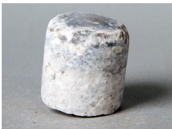
Рис. 4.25. Венёвский горизонт. А – ангидрит (кern с глуб. 2351 м); Б – доломит (кern с глуб. 2372 м). Ореховская опорная скважина. СОИКМ.
