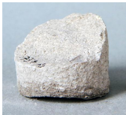
Рис. 4.50. Подольский горизонт. Известняк (керна с глуб. 1705 м). Ореховская опорная скважина. СОИКМ.
