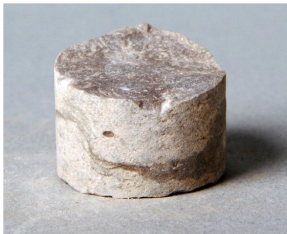
Рис. 4.2. Малёвский горизонт. А – известняк (кern с глуб. 2774 м), Ореховская опорная скважина, СОИКМ
