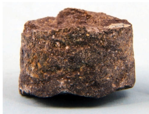
Рис. 3.9. Воробьёвский горизонт. А – распространение и мощность (по: Потёмкин, 2015). Б – гравелит (кern с глуб. 3780 м), Ореховская опорная скважина (Алексеевский р-н). СОИКМ.
