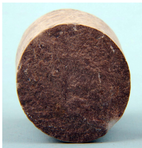
Рис. 3.43. Хованский горизонт. Известняк (керна с глуб. 2787 м), Ореховская опорная скважина; СОИКМ.
