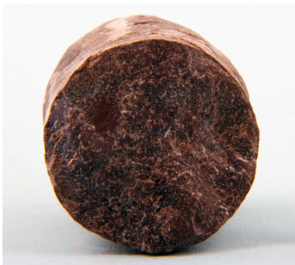
Рис. 3.27. Тиманский горизонт. А – известняк (кern с глуб. 3628 м), Б – глина (кern с глуб. 3624 м), Ореховская опорная скважина; СОИКМ.
