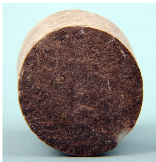
Рис. 3.36. Воронежский горизонт. Известняк (кern с глуб. 3519 м), Ореховская опорная скважина; СОИКМ.
