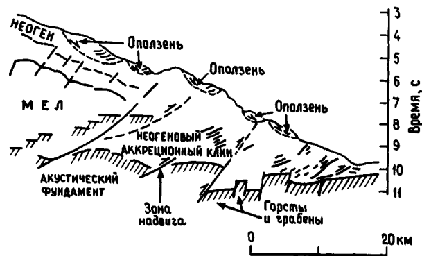
Рис. 14.35. Структурный профиль внутреннего склона Японского желоба мористее северной части острова Хонсю; видны подводные оползни [1827]. Возможно, небольшое значение имеет неогеновая аккреция.
