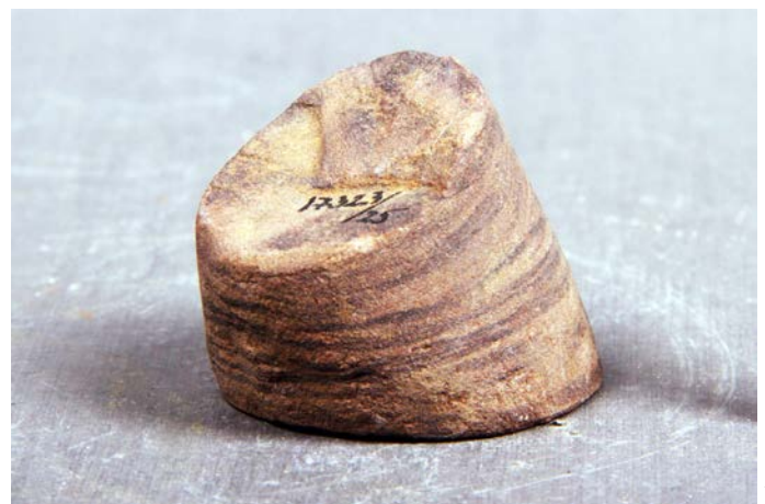
Рис. 9. Боровская свита. А – аргиллит (кern с глуб. 2530 м), с. Елховка; Б – песчаник (кern с глуб. 2675 м), с. Султангулово (Похвистневский р-н). СОИКМ, фото Д.В. Варенова.
