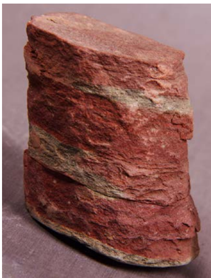
Рис. 9. Боровская свита. А – аргиллит (кern с глуб. 2530 м), с. Елховка; Б – песчаник (кern с глуб. 2675 м), с. Султангулово (Похвистневский р-н). СОИКМ, фото Д.В. Варенова.
