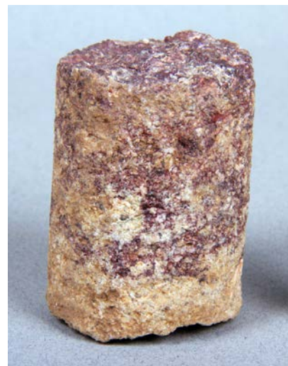
Рис. 7. Боровская свита. Гравелит полевошпатово-кварцевый, переходящий в песчаник (кern с глуб. 2835 м), с. Елховка). СОИКМ, фото Д.В. Варенова.
