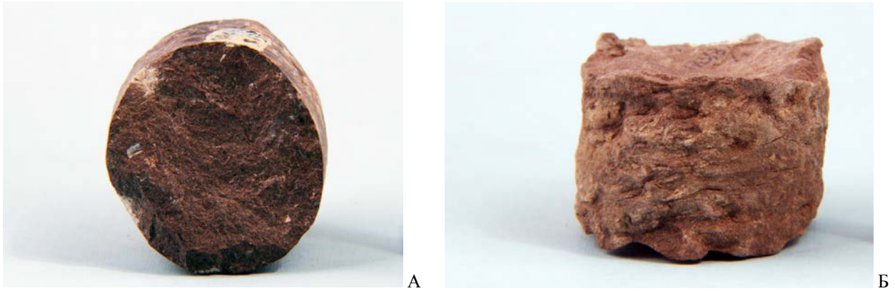
Рис. 17. Муллинский горизонт. А – известняк (кern с глуб. 3706 м); Б – глина (кern с глуб. 3688 м). Ореховская опорная скважина. СОИКМ.
