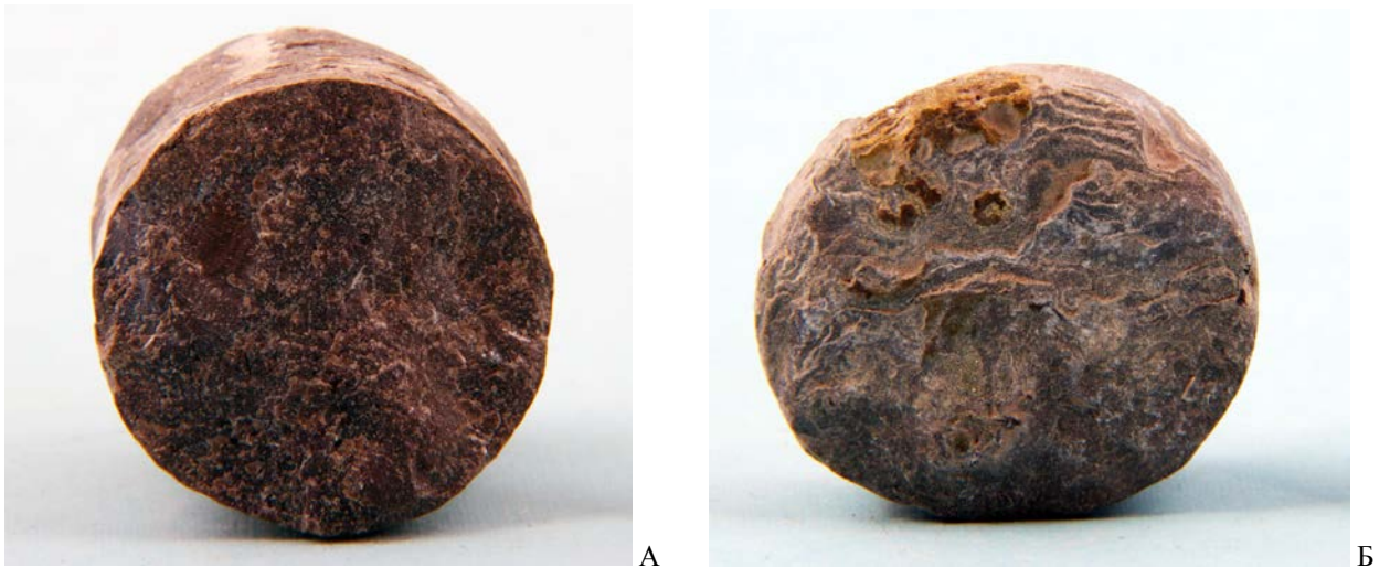
Рис. 26. Тиманский горизонт. А – известняк (кern с глуб. 3628 м), Б – глина (кern с глуб. 3624 м), Ореховская опорная скважина. СОИКМ.
