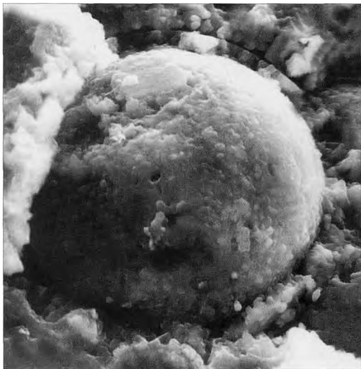
с. Глобула кальцитового состава диаметром 30 мкм в известняке тонкомелкозернистом
