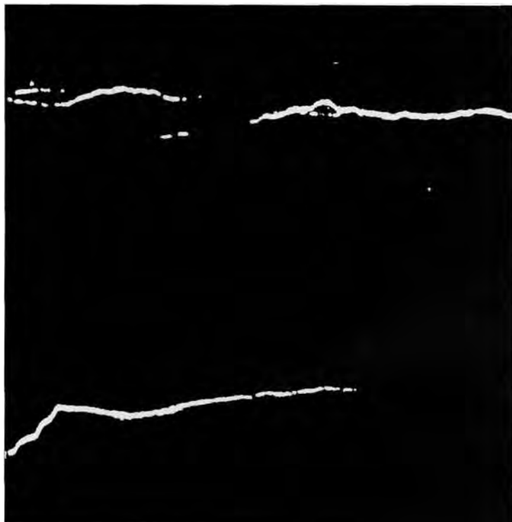
а. Параллельные трещины в непроницаемой матрице известняка микрозернистого
