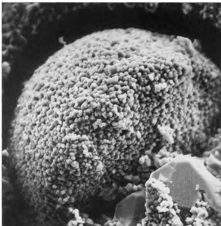
а. Глобула кальцитового состава диаметром 220,5 мкм в известковистом доломите
