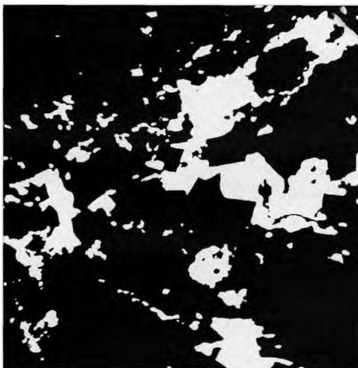
h. Вторичная унаследованная кавернозность в водорослевом известняке.
