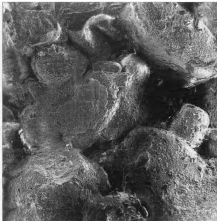
е. Межгранулярная пористость в комковатом перекристаллизованном известняке
