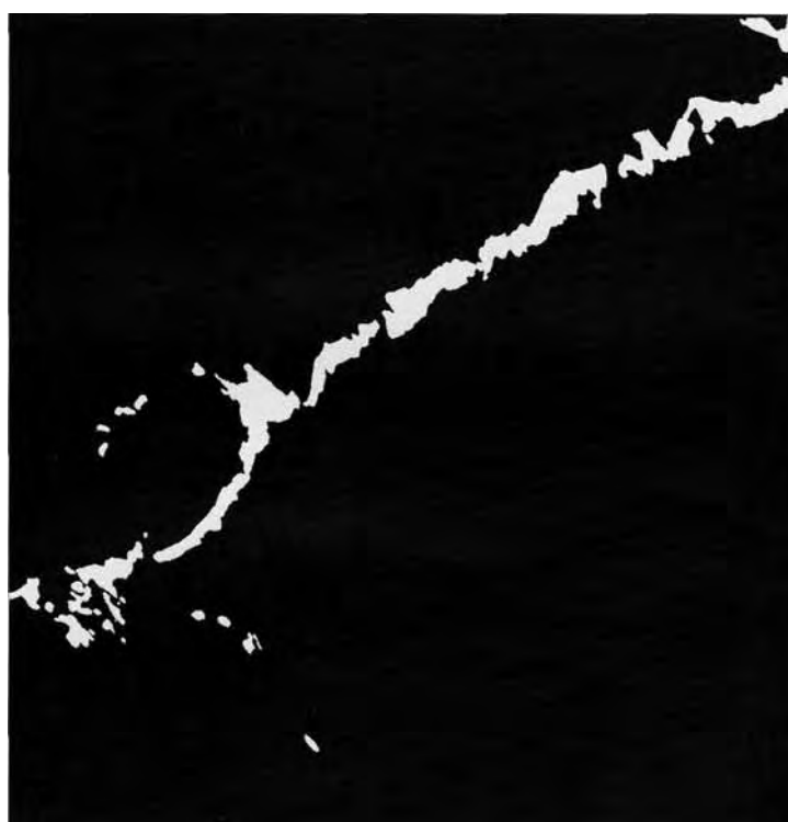
с/. Прерывистость трещин в анкерите, связанная с вторичным минералообразованием
