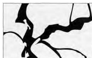
полости выщелачивания вдоль трещин
