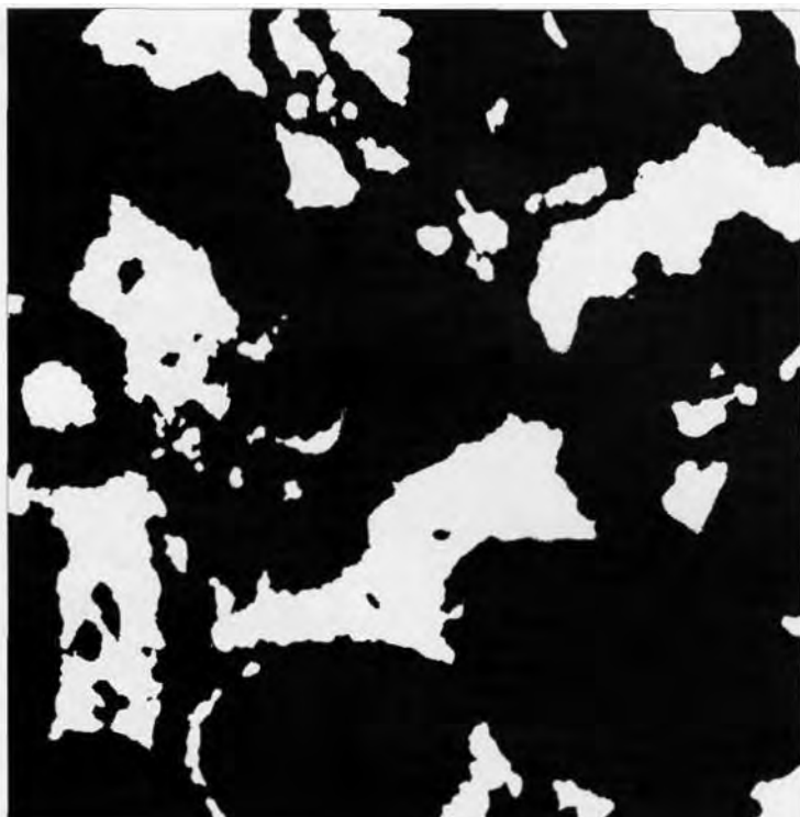
ф. Межгранулярная пористость в комковатом перекристаллизованном известняке
