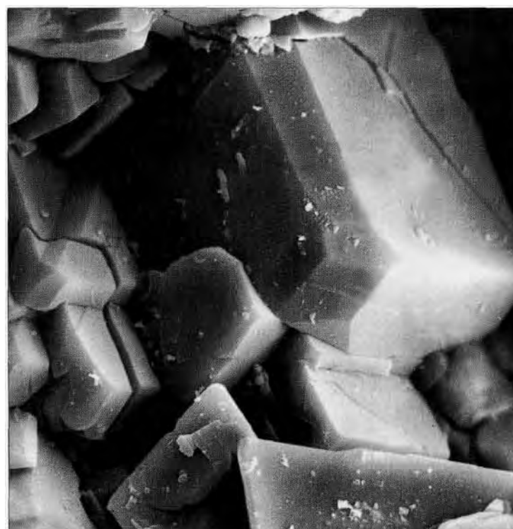
д. Образование трещин на поверхности кристаллов кальцита в органогенно-обломочном известняке под действием давления
