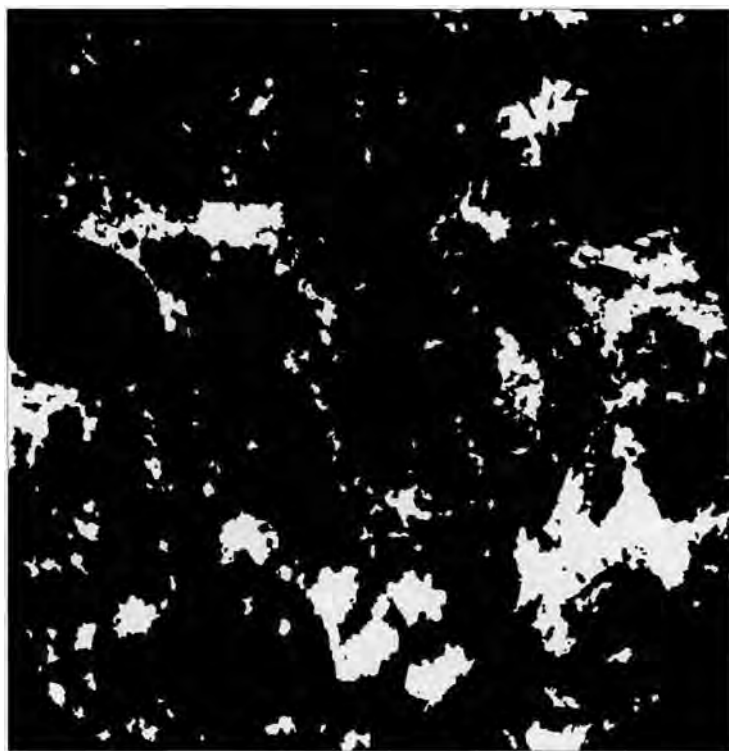
б. СЭМк. Известняк. В катодолюминесценции белые пятна — поры, заполненные катодолюминофором;
