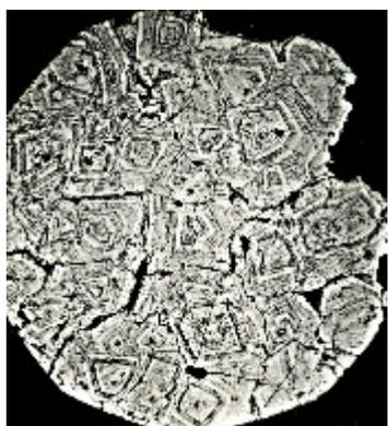
**Рис. 44.** Тонкокристаллический равномерно-зернистый агрегат пирита с зональным внутренним строением кристаллов. Восточный Казахстан, Сулучекинское месторождение. (Отраженный свет, ник. II, увел. 500×). Фото Ю.В. Яшунского
